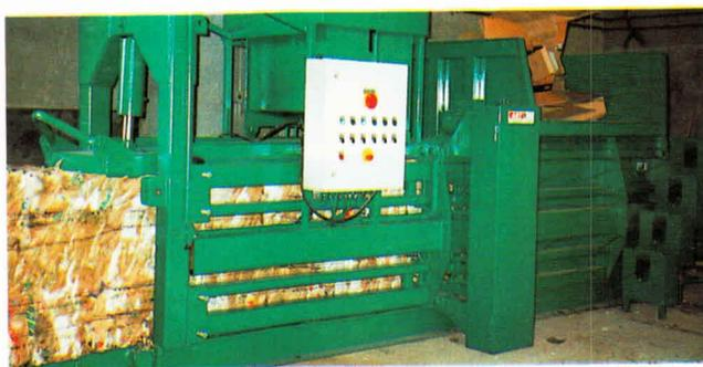
ABT 4000 Vollautomat mit Handbefüllung und Gabelstapler-Kippbehälter in der Industrieentsorgung.
