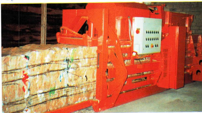
ABT 4000 Vollautomat mit Schneidkantenfreistamper im Altpapier-Entsorgungsbetrieb bis 400 Tonnen / Monat.
