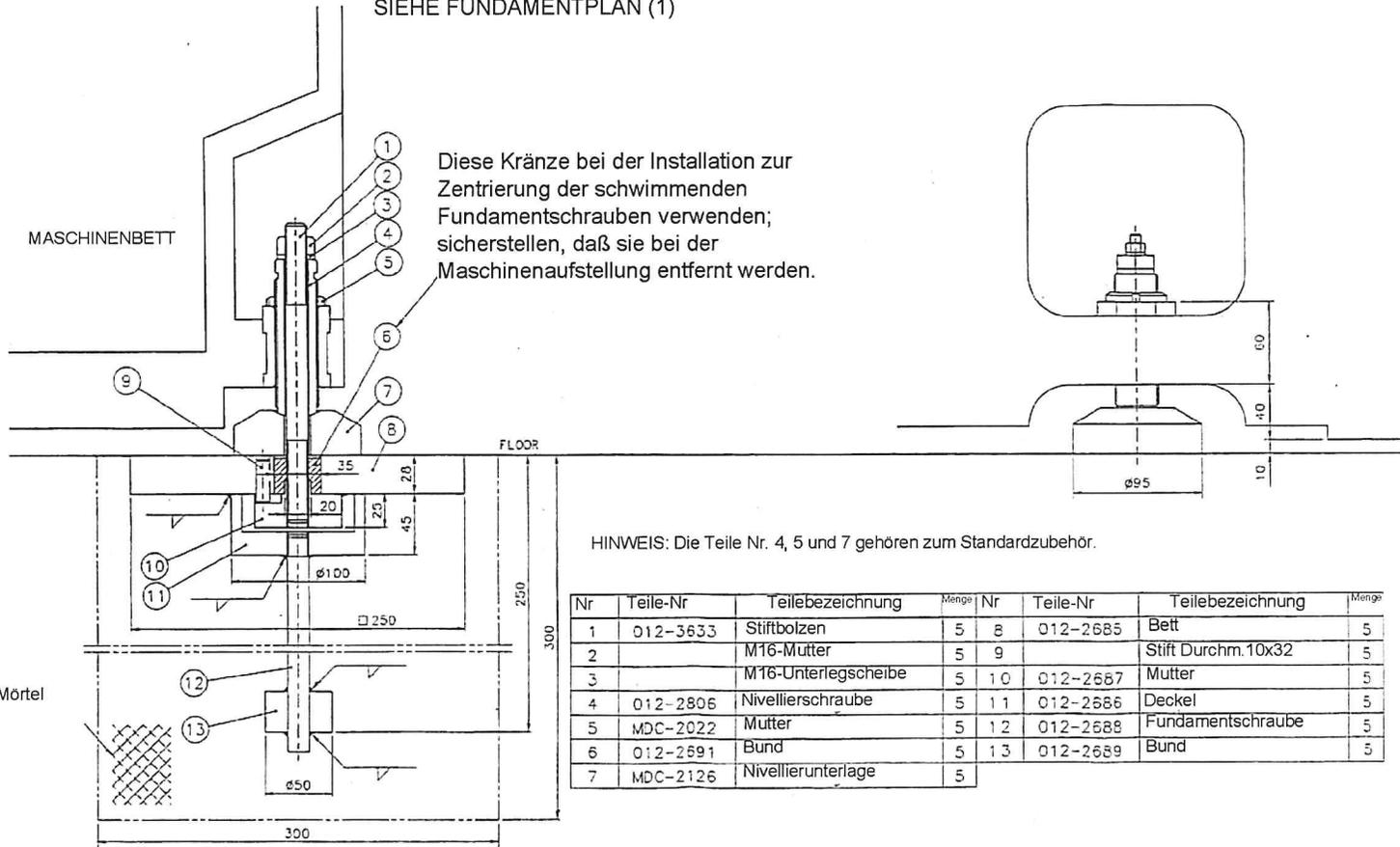
Diese Kränze bei der Installation zur Zentrierung der schwimmenden Fundamentschrauben verwenden; sicherstellen, daß sie bei der Maschinenaufstellung entfernt werden.
