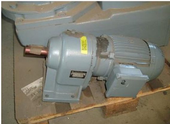
2594 Getriebemotor 1,5 kW 220/400 V
