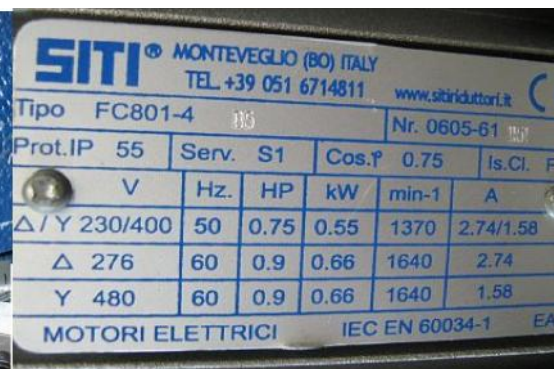
2597 Getriebe + Motor 0,55 kW, 230/400 V, 50 Hz, SITI MNHL 30/2 G6 / FC 801-2007
