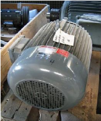
2597 Getriebe + Motor 0,55 kW, 230/400 V, 50 Hz, SITI MNHL 30/2 G6 / FC 801-2007
