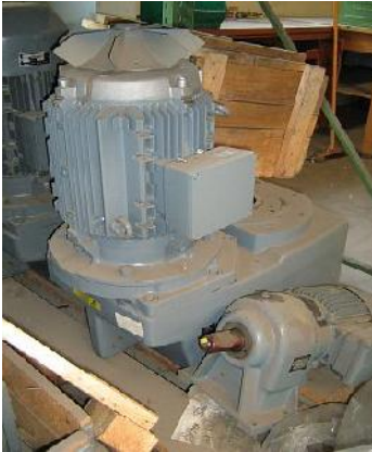
2593 Getriebemotor 1,5 kW 220/400 V / 50 Hz,
