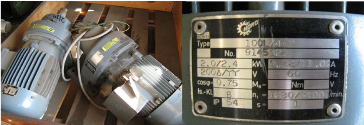
2606 Getriebemotor 2,0/2,4 kW, 200 V/60 Hz, IP 54 Getriebebau NORD 100 L/4-2
