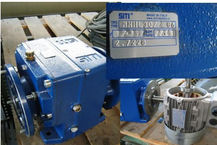
2597 Getriebe + Motor 0,55 kW, 230/400 V, 50 Hz, SITI MNHL 30/2 G6 / FC 801-2007
