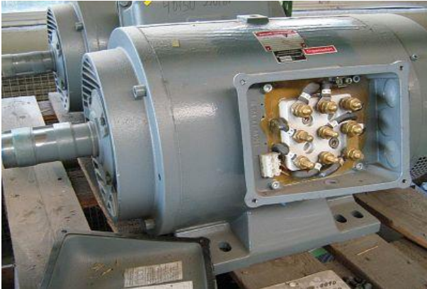
2599 Elektromotor 40/50 kW 220 V / 60 Hz, 138/190 EMOD
